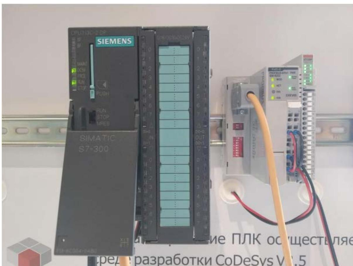
Для интеграции сетевого адаптера Crevis, а также всех поддерживаемых модулей расширения в среду разработки SIMATIC Manager используется файл-описатель (GSD файл).
